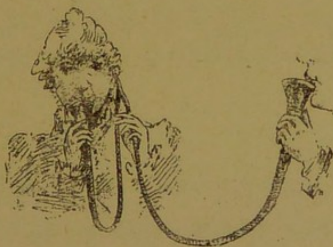
Fig. 24. — Tube acoustique à trois branches.
