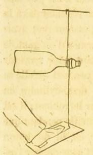
La corde a environ 3 lignes de diamètre; elle est fixée solidement en l'air par l'un de ses bouts; à l'autre bout est attachée une planchette sur laquelle on peut appuyer avec le pied pour tendre la corde; on fait faire à celle-ci un tour autour de la capsule posée sur la bouteille; on appuie le pied pour tendre
