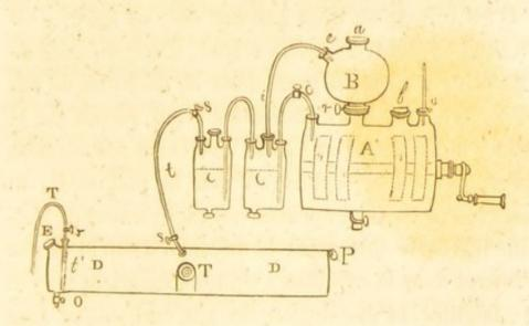
A est un vase en cuivre fort épais, dans lequel le gaz doit être produit. Il est traversé par un agitateur; il porte à sa partie inférieure une ouverture qui sert à le vider; à sa partie supérieure se trouvent : 1° une tubulure a sur laquelle s'adapte un manomètre; 2° une ouverture plus grande b par laquelle on in-
