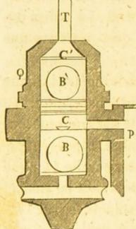
La bille supérieure B' établit ou ferme la communication de la pompe avec le tonneau ré cipient ; elle pose également sur un diaphragme en cuir, et se trouve arrêtée dans sa marche ascendante par la petite pièce C'.
