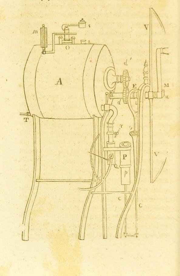
resse. En arrière est le tube de verre qui fait connaître à chaque instant la hauteur du liquide; T est un tube qui conduit l'eau gazeuse dans le robinet.
