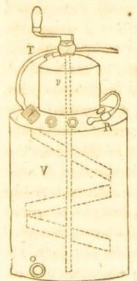
Pour opérer avec l'acide sulfurique, on se sert avec avantage de l'appareil suivant. C'est un vase en plomb V dans lequel on introduit par une tubulure de la craie pulvérisée et délayée dans trois fois et demie son poids d'eau.
