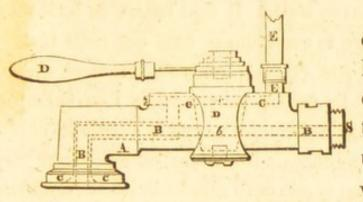
A est le corps du robinet qui s'adapte sur le tonneau par un pas de vis.
