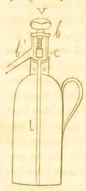
cissement sur lequel vient poser un petit cylindre en alliage C, terminé par un disque de liége très fin, attaché avec de la cire à cacheter : quand le liége est appuyé exactement sur le rétrécissement, il intercepte toute communication entre l'intérieur de la bouteille et l'extérieur. Ce petit cylindre tient à une vis terminée par un bouton ou par une pièce V; vers sa partie supérieure le cylindre C est garni avec un peu
