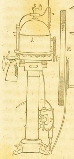
contre, destiné à faciliter le mélange de l'eau et du gaz. Il est mis en mouvement par la manivelle M armée d'un volant, qui fait en même temps marcher la pompe aspirante et foulante. S. est une soupape de sûreté; *m* est un manomètre destiné à faire connaître la pression intérieure; T
