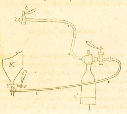
à la main et à la mécanique; on peut aussi, à l'aide du tuyau en étain *a a*, établir une communication entre la bouteille et la partie supérieure du récipient K K, suivant le système dont j'ai déjà parlé. Ce système s'applique heureusement à la préparation des vins mousseux, avec des bouteilles que l'on a eu soin de remplir préalablement d'acide carbonique.
