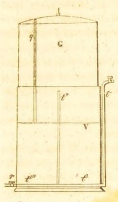
Le gazomètre se compose d'un grand vase V cylindrique en cuivre étamé (il peut être fait en bois) que l'on remplit d'eau, et d'une cloche renversée en cuivre étamé C, qui est tenue en équilibre au moyen d'un contrepoids. Le gaz arrive dans la cloche par le tube t t t"; il en sort par le tube t" t" quand le robinet r est ouvert et
