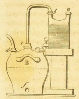
A est un flacon de 20 à 25 litres, destiné à recevoir l'acide chlorhydrique; la tubulure a reste fermée, et ne s'ouvre que lorsque l'acide est consommé et que l'on veut en introduire de nouveau; la tubulure b est munie d'un tube en plomb bien fixé avec un bouchon; ce tube
