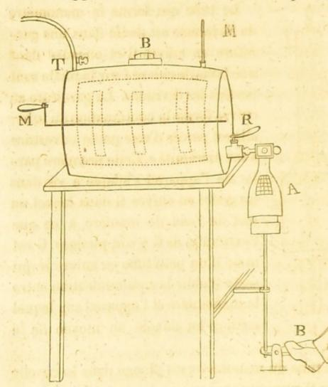
l'eau et le gaz est en cuivre très épais et parfaitement étamé. Sa capacité, qui peut varier, s'élève le plus ordinairement à cent litres. Il est muni à sa partie supérieure d'une ouverture assez grande B, qui
