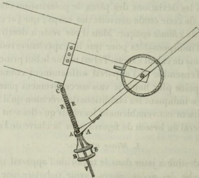
une tige de vis CV, tournant à charnière en C, et passant librement dans un anneau AA porté par le prolongement du miroir. La portion de la tige comprise entre le point d'attache C, et l'anneau AA, est entourée d'un ressort à boudin assez fort pour tendre toujours à repousser énergiquement le mi-
