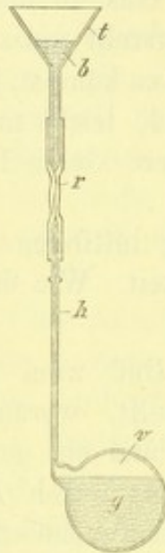
Fig. 3. Infizierung des Gärungskolbens bei Luftabschluss.
