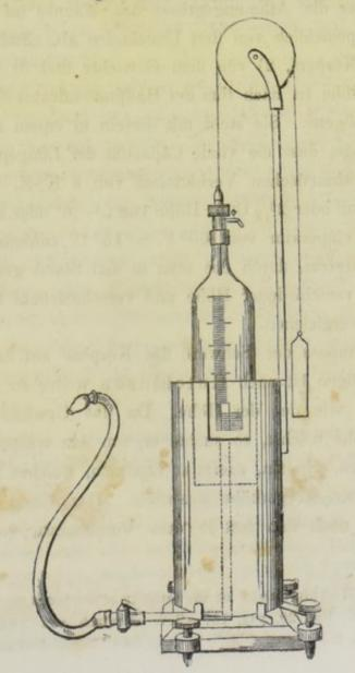
Die Glocke fasst 5500 Ccm. Luft; ihr Cubicinhalt ist durch Theilstriche von je 20 Ccm. Werth bestimmt. Sie läuft oben in eine schmale Röhre aus von etwa 30 Ccm. Inhalt, in der sich ein Thermometerchen befindet. Auf die Röhre ist eine messingene Hülse mit zwei Hähnen gekittet, um das Spirometer zur Untersuchung der Athmungsluft und zur Bestimmung der Lungenelasticität benützen zu können.
