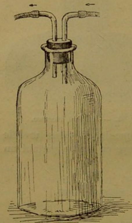
Fig. 66. — Flacon de sûreté pour la trompe à eau.
