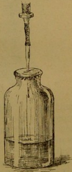
Fig. 11. — Dispositif pour recueillir le liquide filtré au sortir de la bougie.
