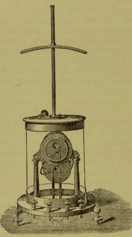
FIG. 1.-THOMPSON'S GALVANOMETER.
