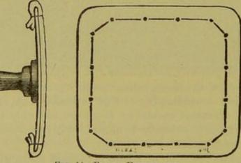
FIG. 14.-PLATE ELECTRODE.
