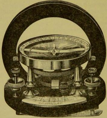
FIG. 20.-TANGENT GALVANOMETER.
