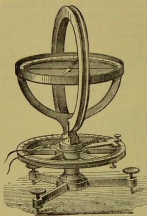
FIG. 22.-SINE GALVANOMETER.
