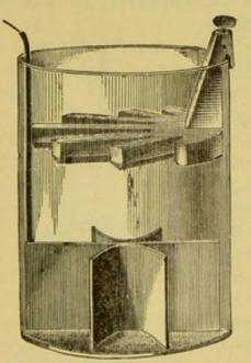
FIG. 46.-GRAVITY BATTERY.
