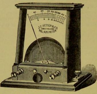
FIG. 25.-HORIZONTAL MIL-AM-METER.
