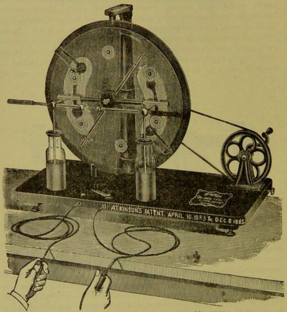
FIG. 6.-ATKINSON'S TOEPLER ELECTRIC MACHINE.
