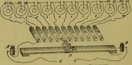
FIG. 67.- APPARATUS FOR COUPLING ELEMENTS.
