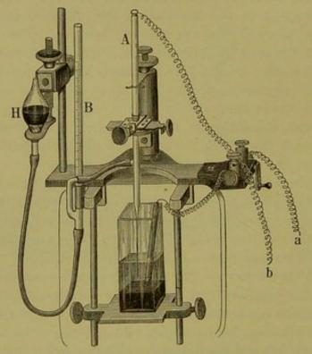
FIG. 5.-CAPILLARY ELECTROMETER.
