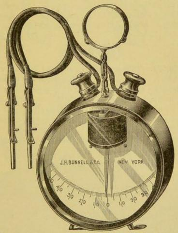
FIG. 28.-THE GALVANOMETER BATTERY POCKET-GAUGE.
