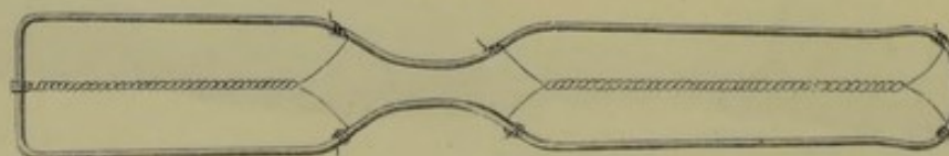
Schwebeschiene aus Telegraphendraht.
