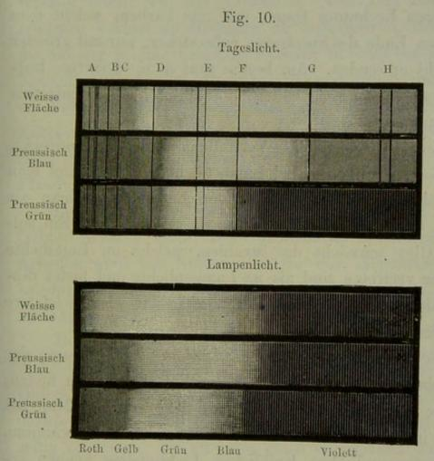
Sehr gut übersieht man diese Verhältnisse in Fig. 10, wo die Spectren von Preussisch-Blau und Preussisch-Grün das eine Mal bei Tageslicht, das andere Mal bei Lampenlicht dargestellt, und die Spectren der beiden Lichtquellen zur Vergleichung beigefügt sind.
