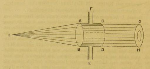
In einem metallenen Rohre ABCD von 5-6 cm. Länge und 5 cm. Breite wurde an der einen Grundfläche AB eine Bergkrystall-linse von 13 cm. Brennweite eingefügt; an der anderen Grundfläche CD wurde eine plane Glasplatte von etwa 2 mm. Dicke festgesetzt. In der Mitte hatte diese Platte ein Loch, in welchem eine Bergkrystallplatte derselben Dicke gekittet war <sup>1</sup>). Das innere des Rohres stand durch die zwei Röhrchen E und F mit der umgebenden Luft in Verbindung.
