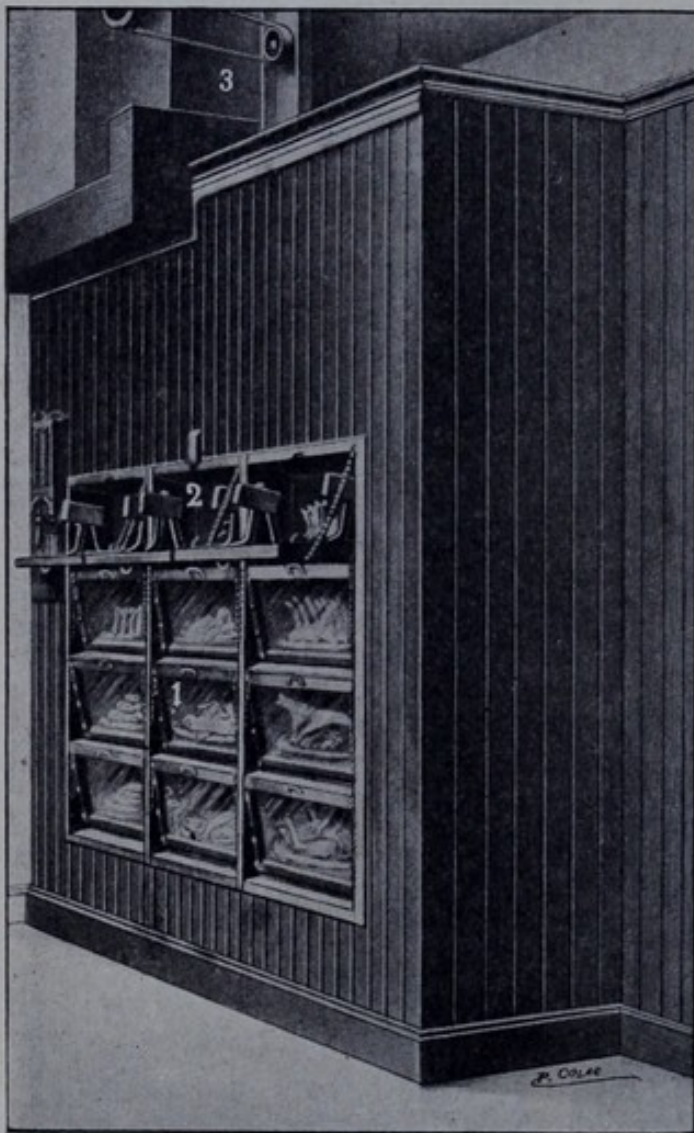
Fig. 11. — Paroi de chambre froide avec garde-manger frigorifique.
