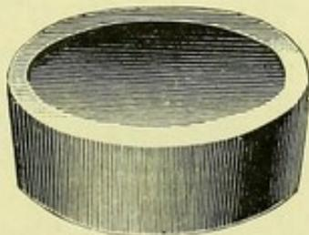
ASBESTOS SOLDERING BLOCK.
