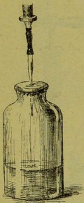
Fig. 12. — Dispositif pour recueillir le liquide filtré au sortir de la bougie.
