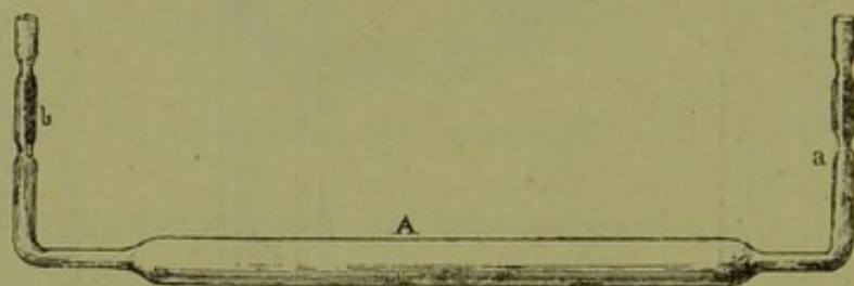
Fig. 86. — Tube de Roux pour culture en plaque dans l'hydrogène.
