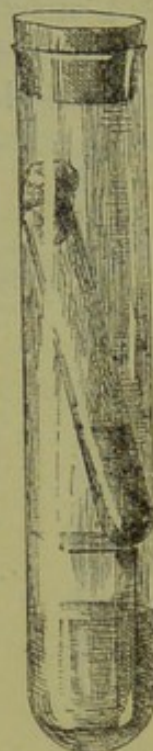
Fig. 77. — Dispositif de Buchner pour la culture des anaérobies.
