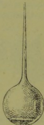
Fig. 28. — Ballon dont le col a été effilé et fermé à la lampe.
