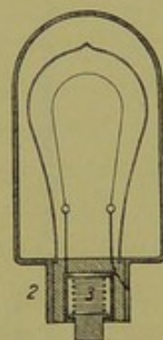
Fig. 38. Cystoskoplampe mit federndem Kontakt.
