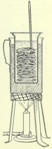
Abb. 3. Vorrichtung zur Cumolsterilisation.
