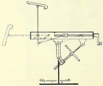
Abb. 19. Operationstisch von Göpel (Konstruktionszeichnung).
