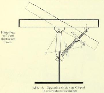
gegeben worden, der durch eine in der mittleren Achse angebrachte Ölpumpe höher und tiefer gestellt und außerdem seitlich geneigt werden kann (s. Abb. 17, 18 u. 19).
