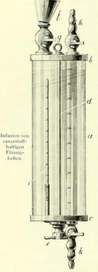
Abb. 45. Apparat zur Infusion sauerstoff haltiger Flüssigkeit.
