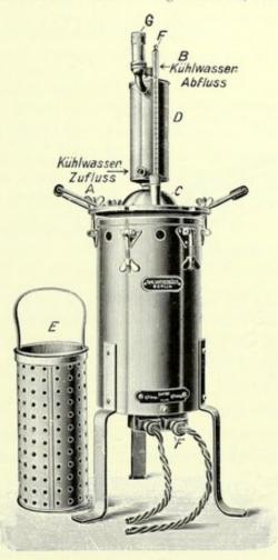
Abb. 6. Apparat zur Cumolsterilisation.
