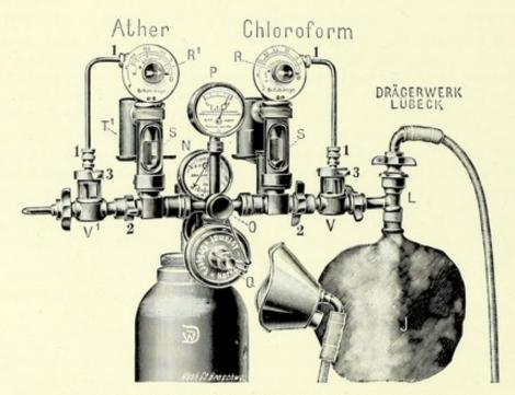
Abb. 40. Apparat zur Mischnarkose mit genauer Dosierung des Narcoticums.
