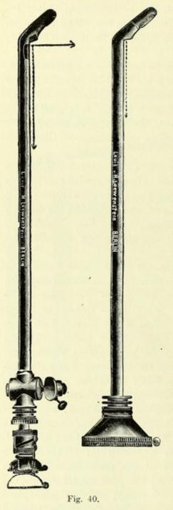
befindet (Fig. 40), so erblickt man die Objekte, die sich innerhalb eines ideellen Kegelmantels befinden, dessen Achse senkrecht auf der anderen gegen den Trichter sehenden Kathetenfläche steht, d. h. man sieht, wie durch unser retrogrades Kystoskop III, die den eingedrungenen Schaft des Instrumentes umgebenden Teile der Blasenwand.
