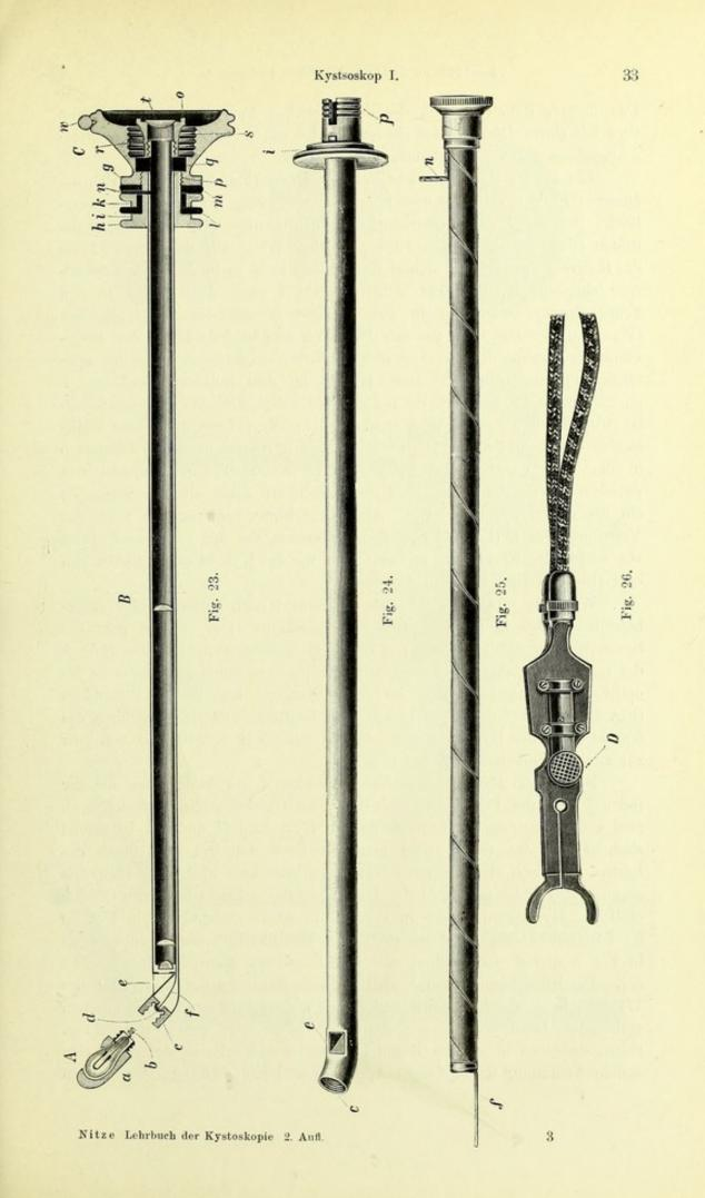
Das dünnere Rohr (Fig. 25), das den optischen Apparat beherbergt, endet vorn mit einem Draht f, der ebenso wie das ganze Rohr mit dünner Goldschlägerhaut überzogen und dadurch isoliert ist.
