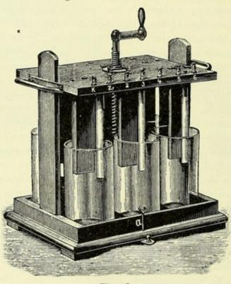
Fig. 47. Tauch-Batterie mit 6 Elementen.
