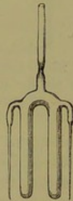
Fig. 22. — Tube Pasteur double.
