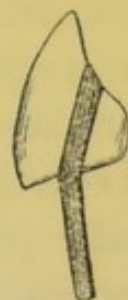
Fig. 78. Pivot Tooth (tube), in section.
