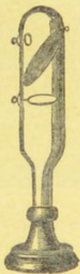
FIG. 11. — Action mécanique de la matière radiante.
