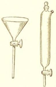
Fig. 26. Chemical Separators.
