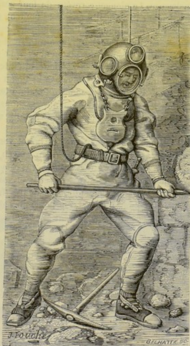
Fig. 7. — Scaphandrier pourvu du régulateur Denayrouze, costume complet.
