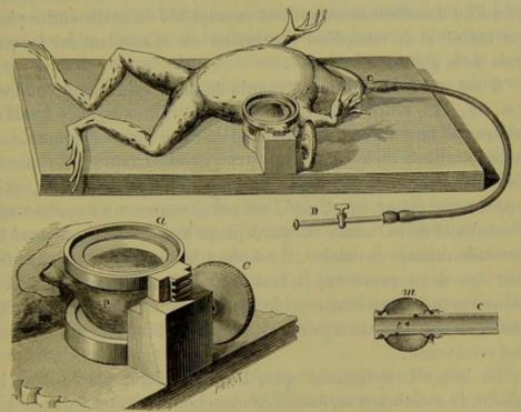
Fig. 212 — Appareil de Holmgren pour l'observation de la circulation dans le poumon de la grenouille. — c, canule introduite dans la glotte; m, membrane distendue pour obtenir l'obturation au moment de l'insufflation; D, canule à robinet; a, cercle de laiton portant une lamelle de verre que l'on peut abaisser sur le poumon P, en se servant de la crémaillère c.
