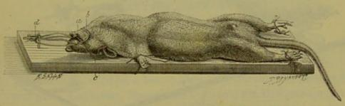
Fig. 30. — Appareil pour immobiliser les rats.
