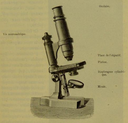
Fig. 2. - Microscope composé.
