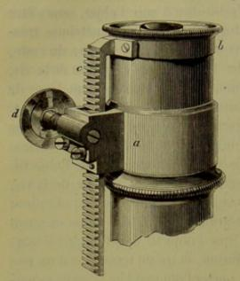
Fig. 4. — Crémaillère micrométrique oculaire pour la mise au point.
