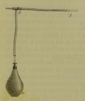
Fig. 164. — Appareil à respiration artificielle pour le lapin. — a, poire en caout-chouc; b, tube en cuivre à soupape; t, canule en verre avec un petit trou latéral. — ½ diam.
