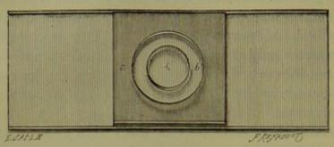
Fig. 25. — Chambre humide à air : s, disque sur lequel on place les éléments et le liquide destinés à l'examen; b, rigole contenant de l'air; c, plaque sur laquelle reposent les bords de la lamelle.
