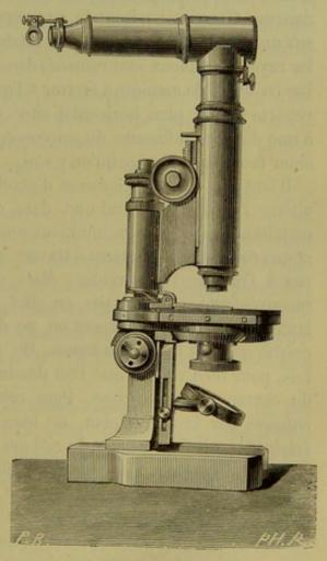
Fig. 19. — Chambre claire d'Oberhaeuser adaptée au microscope.
