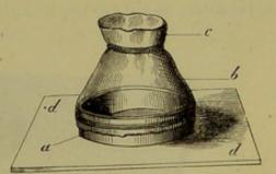
Fig. 24. — Chambre humide de Recklinghausen: d, lame de glace; a, bordure circulaire de verre autour de laquelle est appliquée la membrane de baudruche b; c, lien circulaire destiné à fixer le manchon de baudruche sur l'objectif.
