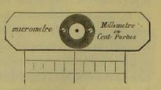
Fig. 17. - Micromètre-objet.
