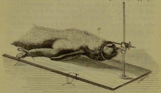
Fig. 31. - Appareil pour immobiliser les lapins.
