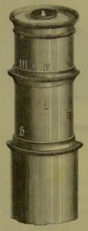
Fig. 53. - Partie supérieure du microscope, avecdes traits gravés sur le tube rentrant et des chiffres indiquant les nu-
