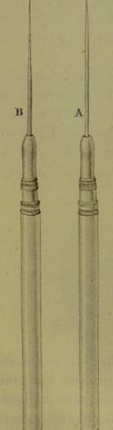
Fig. 27. — Aiguilles pour la dissociation des tissus, disposées sur des porte-mine.
