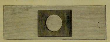
Fig. 40. - Porte-objet à cellule pour préparations.
