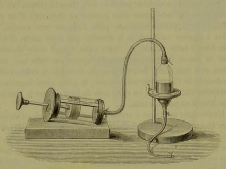
Fig. 39. — Appareil à injection pour les liquides qui attaquent le métal ou le piston de la seringue.
