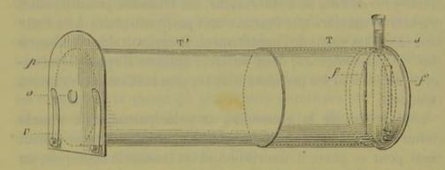
Fig. 479. — Myospectroscope. — p, platine sur laquelle on fixe la préparation de muscle à l'aide de valets, v; T', tube principal, à l'une des extrémités duquel se trouve la fente f du spectroscope; T, tube que l'on ajoute pour l'examen spectroscopique du sang, et à l'extrémité libre duquel se trouve la fente f', dans laquelle est engagé le tube à analyse s, contenant la solution de sang.
