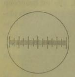
Fig. 18. — Micromètre oculaire.
