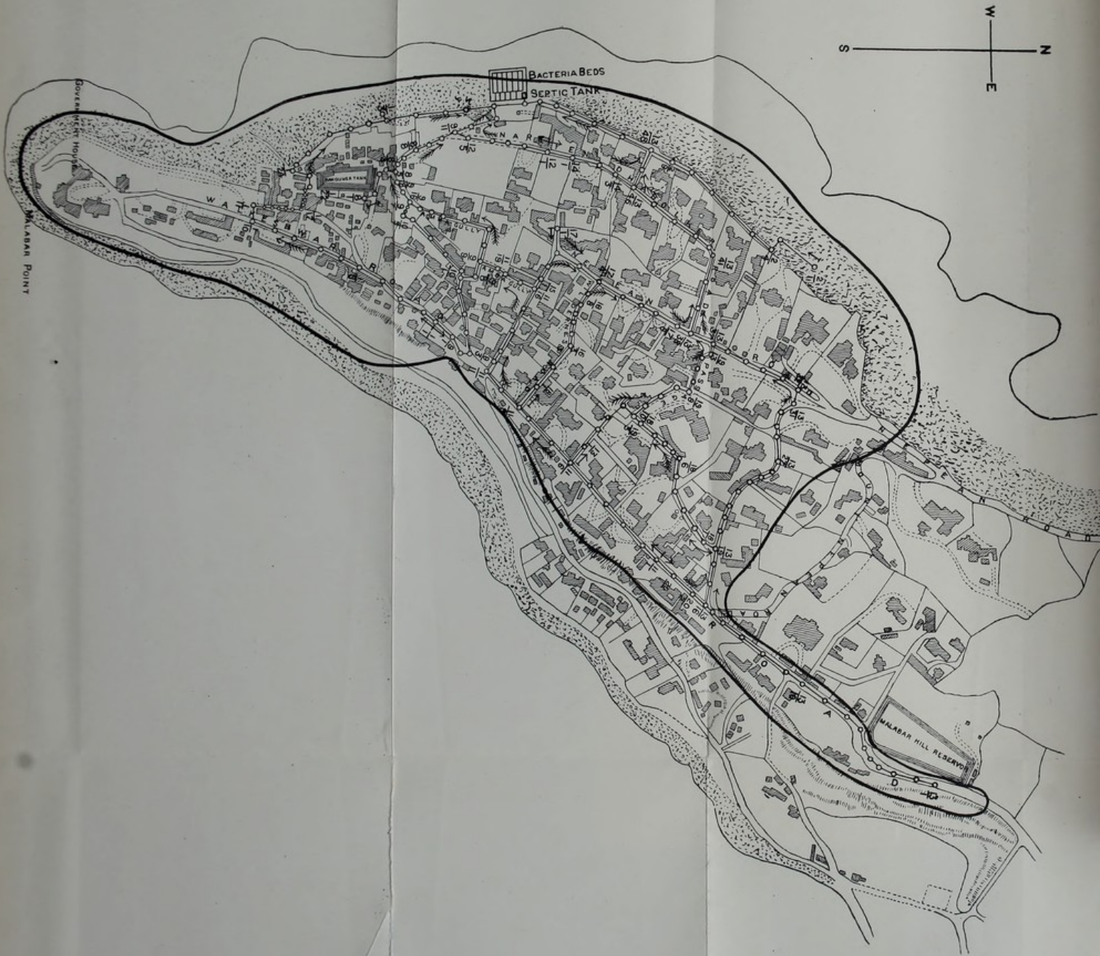
FIG. XV (d).—Drainage Scheme of Malabar Hill, Bombay.
