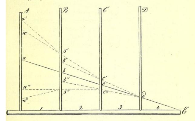
Es sei EE' eine elastische Röhre von gleichmässiger Weite, durch welche in der Richtung von E nach E' das Wasser strömt. Diese Röhre zerfalle in 4 gleich grosse Abschnitte, 1, 2, 3, 4, und am Anfange jedes dieser Abschnitte befinde sich ein Druck- oder Wellenmesser, A, B, C, D.
