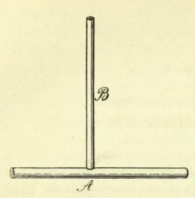
Uebt das Fluidum einen Seitendruck aus, d. h. drängt es gegen die Wandungen der Röhre A, so wird es auch in die offene Seitenröhre B, eindringen, und bis zu einer gewissen Höhe emporsteigen müssen. Das Ansteigen der Flüssigkeit in der Seitenröhre B wird so lange fortdauern, bis der Seitendruck, welcher das Fluidum hebt, und als eines sehweren, sich in's
