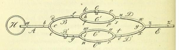
wurde bei B' in dem zweiten Abschnitte und bei C in dem dritten Abschnitte ein Hahn angebracht, dessen Bohröffnung die Weite der Röhren hatte. Wurde der Hahn bei C geschlossen, so konnte das Wasser durch die Röhre, an welcher er angebracht war, nicht durchtreten, floss also im dritten Abschnitte nur durch drei Collateralröhren, statt durch vier, im Ganzen aber nur durch 9 Röhrensegmente, statt vor Schliessung des Hahnes durch 40.
