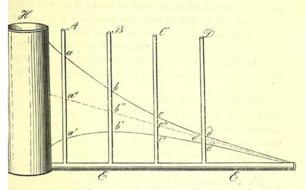
Jemehr man die stossweise Wirkung der bewegenden Kraft in einen gleichmässigen Druck verwandelt, um so mehr müssten sich die Höhenstände a b c d einerseits, und die Tiefenstände a' b' c' d' andrerseits dem Wasserstande des Mitteldrucks a" b" c" d" nähern, und mit gänzlichem Verschwinden des Stosses würde ein gleichmässiges Fliessen eintreten, d. h. die Curven der Höhen- und Tiefenstände würden mit der Curve des mittleren Seitendrucks zusammenfallen.
