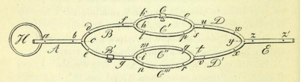
Unmittelbar am Boden eines Wasserbehälters H (hier nur im Grundriss sichtbar), wurde eine Röhre A in horizontaler Richtung angebracht, welche das ihr zufliessende Wasser an die ebenfalls horizontal liegenden beiden Röhren B und B' abgab, Von letzteren beiden Röhren theilte sich jede wiederum in zwei Arme, nämlich B in C C' und B' in C'' C'''. Ein Blick auf die
