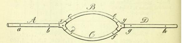
Jede Röhre war also 500 Millimeter lang und hatte eine Durchschnittsfläche von  $38,81 \square Millimeter$ . Die erste Röhre A dieses kleinen Apparates war in ein Gefäss H eingeführt, welches mit Hülfe des schwimmenden Hebers gleichmässig voll Wasser gehalten wurde. Auch hier sammelte ich das binnen 2 Minuten ausfliessende Wasser, um die Geschwindigkeit der Strömung berechnen zu können, und bestimmte aus der Druckdifferenz bei a und b den Seitendruck an der Einflussmündung des Apparates.
