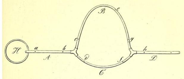
In diesem Apparate haben alle Röhren die gleiche Weite von  $38,81 \square$  Millimeter, dagegen hat B die doppelte Länge der übrigen, nämlich 4000 Millimeter statt 500. Die Druckmesser a, b, c u. s. w. sind nach dem schon mehrmals erwähnten Princip angebracht (§ 33), nur ist für B zu bemerken, dass die Distanz zwischen c und e 500 Millimeter, die zwischen e und g 300 Millimeter beträgt. Als Wassser durch den Apparat strömte, zeigte sich Folgendes:
