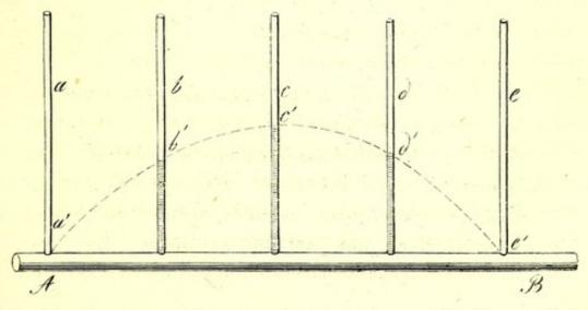
bei a b c de seien Wellenmesser aufgesetzt, und in diesen steige das Wasser in Folge des Stosses im Wellenmesser a bis a', in b bis b' u. s. w. Unter diesen Voraussetzungen ist die punktirte Linie a' b' c' d' e' die Curve der Höhenstände, durch welche die Form der positiven Welle gegeben ist.
