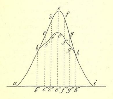
erfährt eine Correctur durch die Welle des Schlauches, deren Ordinaten in der Figur mit  $c\,c',\,d\,d',\,e\,e',\,f\,f',\,g\,g'$  bezeichnet sind. Da die Schlauchwelle den Druck mindert, so sind ihre Ordinaten von denen der Flüssigkeitswelle abzuziehen, und es bleibt daher als Rest der Curve  $a\,b\,c'\,d'\,e'\,f'\,g'\,h\,i$ , womit die unregelmässige Form der Welle mit 3 Elevationen gegeben ist.
