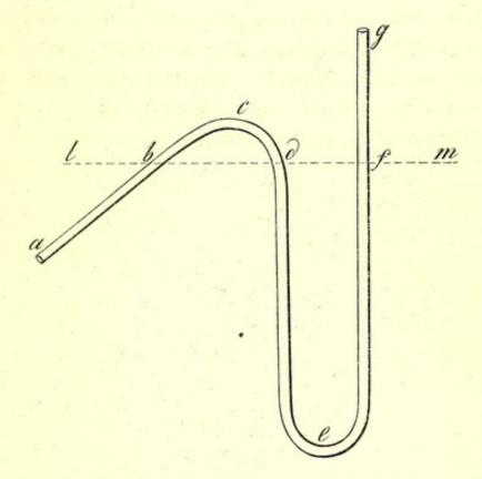
Es sei a b c d e f g eine Röhre, welche bei a verschlossen und mit Ausnahme des Abschnittes fg vollständig mit Wasser gefüllt ist. Ferner sei lm eine Wagerechte, welche den höchsten Wasserstand in f schneidet. Nun werde die Röhre bei a geöffnet, dann wird nothwendig das Wasser unter das frühere Niveau bei f herabsinken und aus dem nach unten gerichteten Röhrenschenkel a b c theilweise auslaufen müssen. In communiciren-
