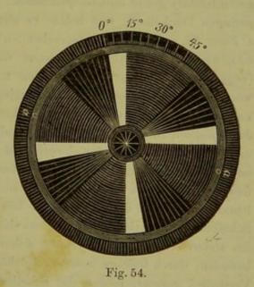
die Ausschnitte, also die Theile, welche Licht durchlassen, vergrössert und verkleinert werden. Wird der Episkotister in schnelle Rotation versetzt, so wird er
