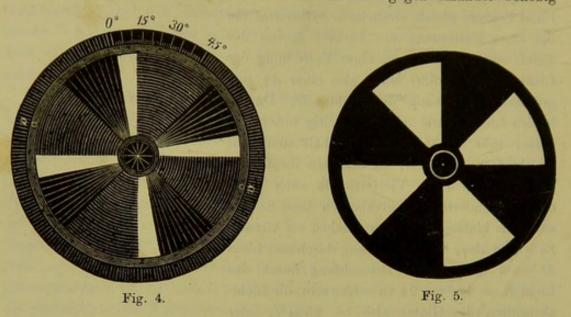
ändern, und an dem man die Menge des durchgehenden und des abgehaltenen Lichtes durch Ablesen der Grade genau bestimmen kann.
