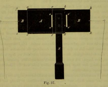
Figur 37 stellt den Apparat zum Verschieben der Objecte dar. Das eine Object befindet sich an dem feststehenden Rahmen A, das andere auf der verschiebbaren Tafel B. Der Rahmen A oder abcd besteht aus einer dünnen hier nicht sichtbaren Holzplatte, welche an der oberen Seite ab und der untern Seite
