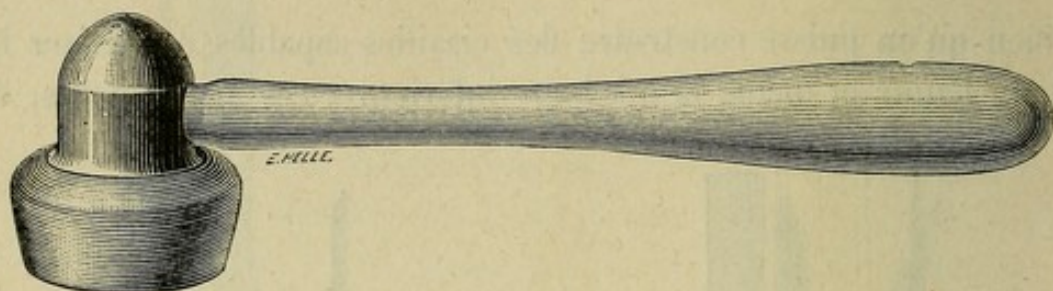
FIG. 539. — Mon marteau plomb et bois. La masse, comme celle du brochoir du maréchal-ferrant, étant d'un seul côté du manche, celui-ci n'a pas de tendance à tourner dans la main. Le poids est considérable, le volume petit, la surface de frappe large et résistante.
