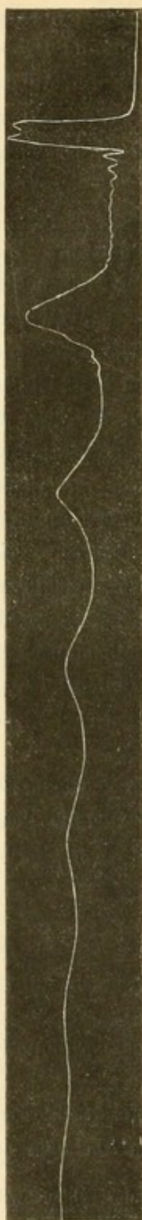
Fig. 15. Dämpfung und allmähliche Deformation stehender Wellen in einem beiderseits geschlossenen Schlauche.
