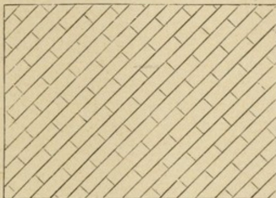
Fig. 71. — Plancher avec joints asphaltés
