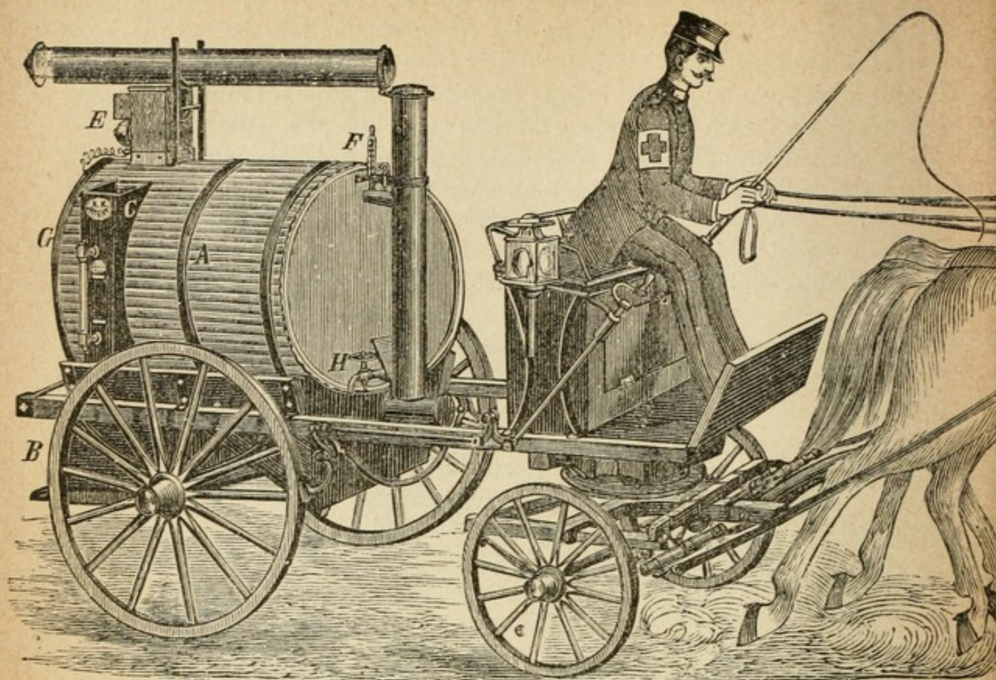
Fig. 186. — Étuve à désinfection transportable de Thursfield.
