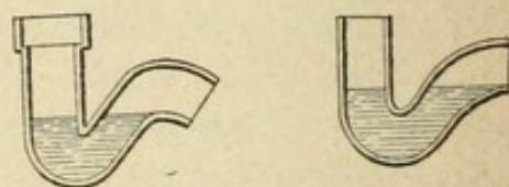
Fig. 93. — Coupe-air de water-closets. Echelle de 4 centimètres par mètre
