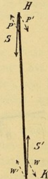
Figur 50. Schema der beim Stehen auf den Unterschenkel wirkenden Kräfte.
