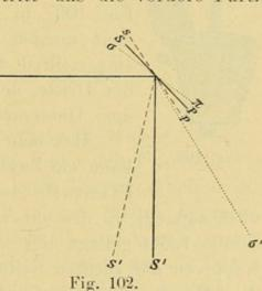
a' b' c' derselben entsprechende Richtung des in das Kehlkopfinnere fallenden Lichtcylinders. SP Kehlkopfspiegel in gew. Winkelstellung, s p mehr senkrechte,  $\sigma \pi$  mehr horizontale Spiegelhaltung. Dementsprechend fällt das Licht senkrecht S', oder mehr nach vorne s' resp. mehr nach hinten  $\sigma'$ .
