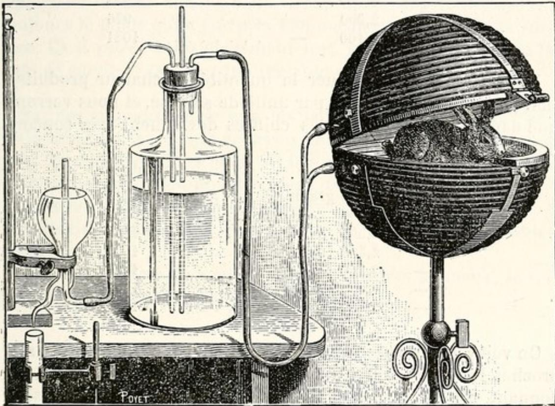
Fig. 30. — Calorimètre à siphon.
