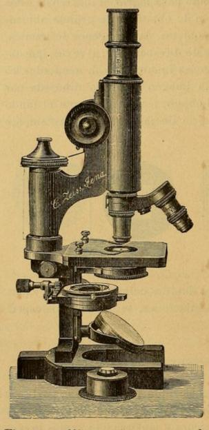
Fig. 12. — Microscopio compuesto de Zeiss. Modelo IV α, con cremallera para el descenso rápido del tubo y aparato iluminador Abbe.
