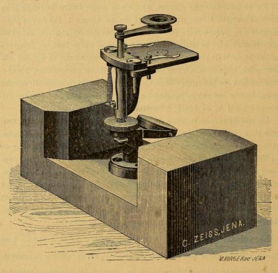
Fig. 2. — Modelo de microscopio simple según Zeiss. El descenso de la lente se opera por tornillo micrométrico.
