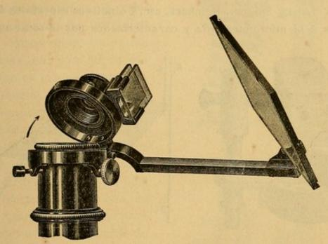
Fig. 26. — Cámara clara de Abbe, vista en posición oblícua para que se tobserve su modo de montaje sobre el ocular.
