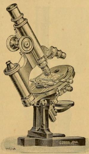
Fig. 15. — Modelo con revólver portaobjetivo, aparato concentrador Abbe y platina movible.
