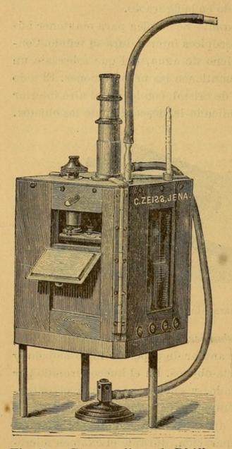
Fig. 41. - Cámara caliente de Pfeiffer.
