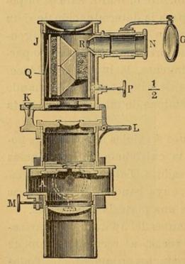
Fig. 33. — Microespectroscopio de Sorby construido por Zeiss.
