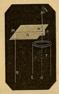
Fig. 24. — Esquema de la cámara de Nachet : T, tubo del microscopio; A, el paralepípedo de cristal; R, rayo que llega del papel; O, rayo emanado del microscopio.
