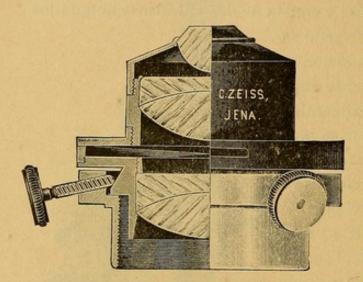
Fig. 14. — Corte del concentrador Abbe acromático.
