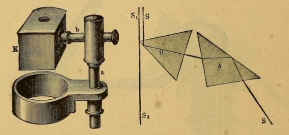
Fig. 27. — Cámara clara de Zeiss : á la izquierda se ve el aparato completo ; á la derecha, su esquema : S, rayo dimanado del papel ; S<sub>1</sub>, rayo llegado del microscopio.
