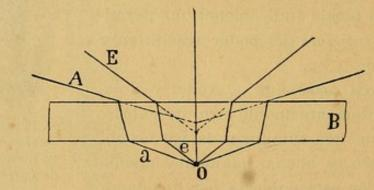
Fig. 18. — Influencia del espesor de la lámina cubre-objetos (B) en la marcha de los rayos luminosos emanados de un punto O de la preparación.
