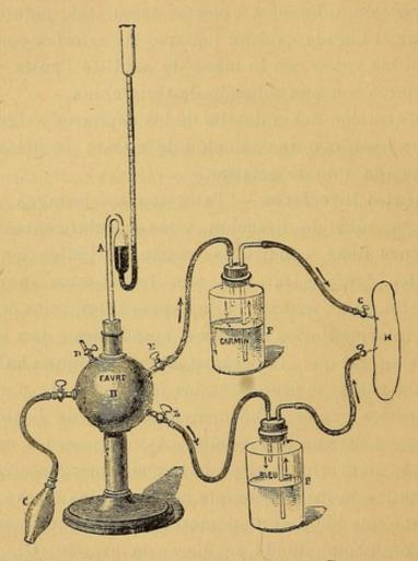
Fig. 42. — Aparato inyector de presión contínua : B, reservorio de aire ; A, manómetro ; C, pera de caoutchouc donde se hace la presión ; F, frascos con las masas de inyección que se mantienen calientes á favor de un baño maría.
