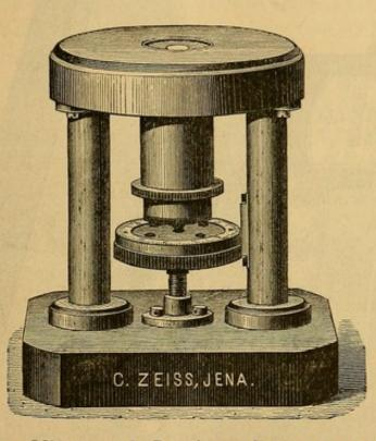
Fig. 35. - Microtomo de Ranvier perfeccionado por Zeiss.
