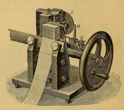
Fig. 39. — Microtomo automático de Minot para practicar secciones en parafina : P, parafina ; Z, rueda dentada unida al tornillo micrométrico.
