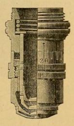
Fig. 17.—Corte vertical de un objetivo apocromático y de corrección.
