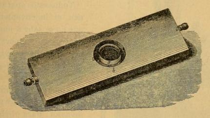
Fig. 40. - Cámara húmeda y para gases.
