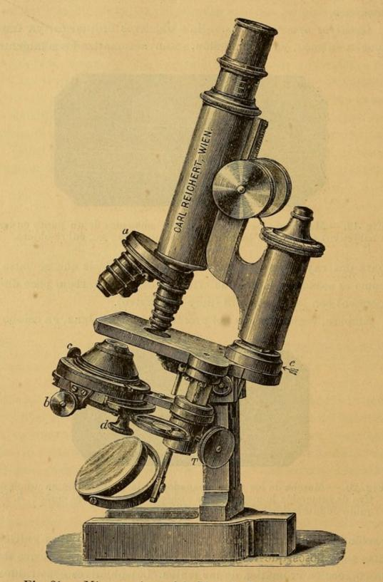
Fig. 21. — Microscopio modelo II, b, de Reichert, provisto del iluminador Abbe y del revólver porta-objetivo.
