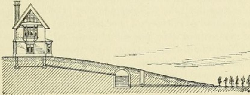
DISPOSAL OF HOUSE DRAINAGE BY SURFACE IRRIGATION.
