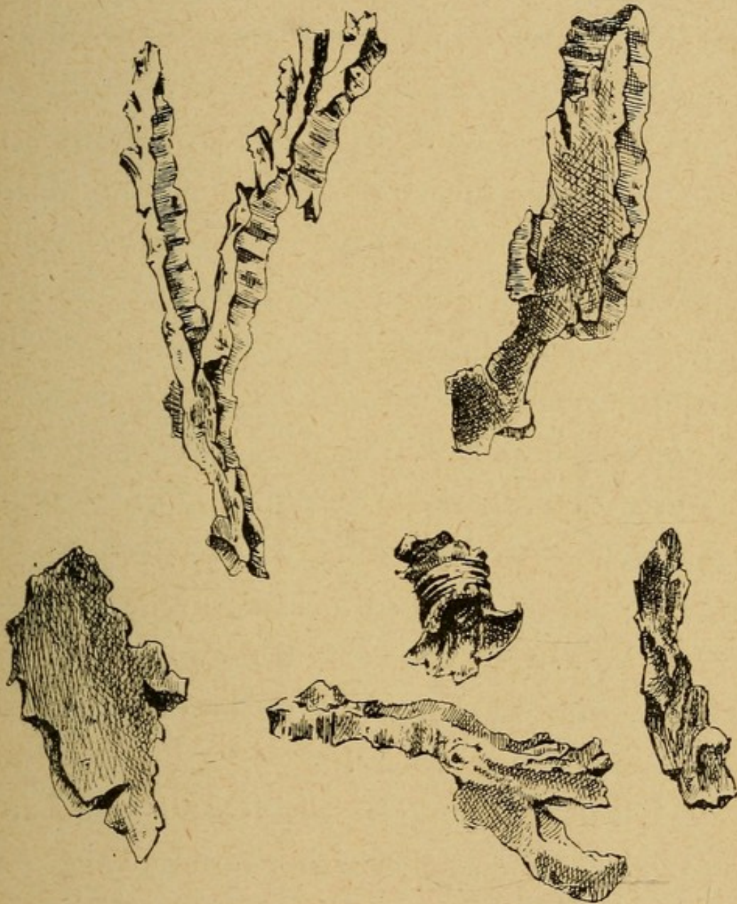
FIG. 17. — Éclats d'obus en acier embouti de 80, chargé à la mélinite.
