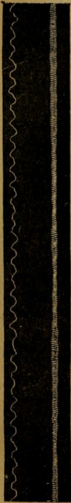
FIG. II. — Graphique de vibrations correctement exécutées, inscrites sur un cylindre enregistreur à marche lente. Emprunté à Laker.
