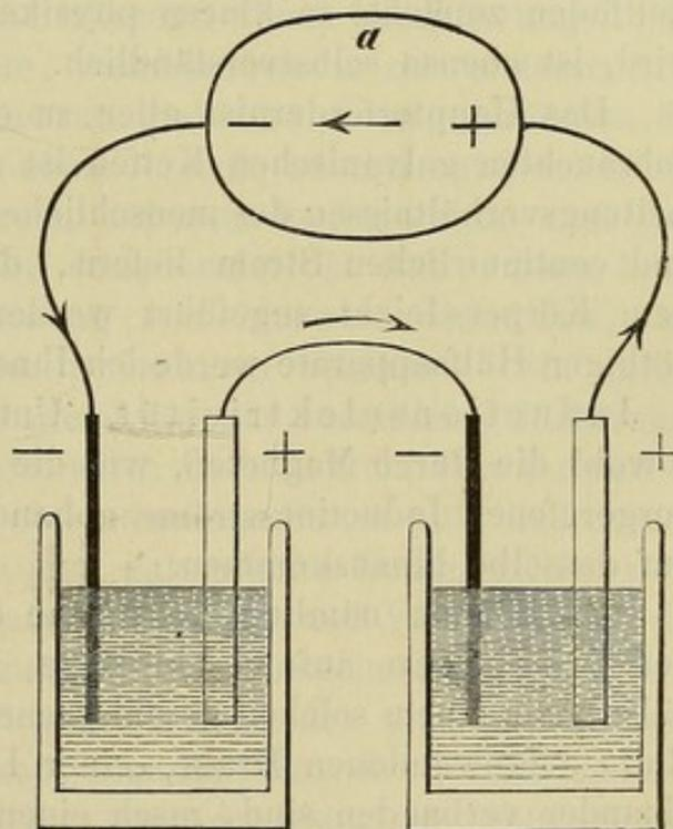
Schema der Einschaltung des menschlichen Körpers (a) in den Schliessungsbogen einer galvanischen Kette.
