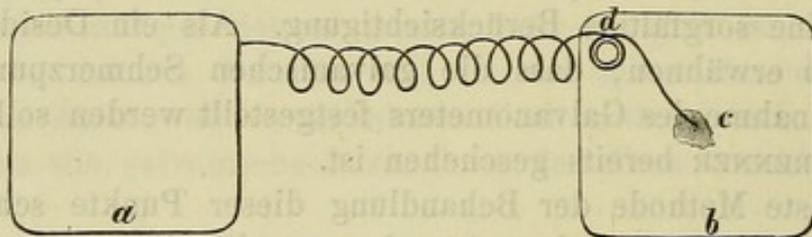
„Einfaches Element“ nach CINISELLI. a = Zinkblech, von vorn, b = Kupferblech, von der Rückseite. Verbindung durch einen mehr oder weniger langen überspannten Kupferdraht. c = Lötstelle, d = kleiner Knopf, um welchen der Draht herumgeschlungen, um das häufige Abbrechen zu verhüten.
