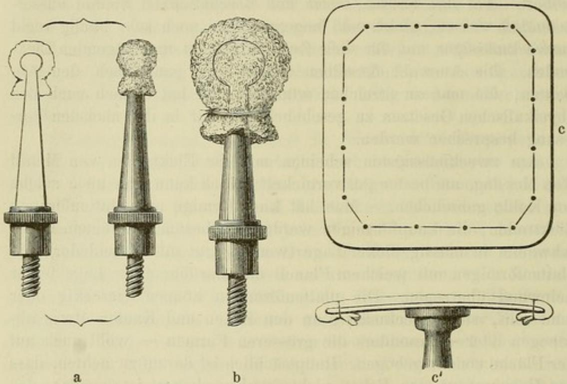
Verschiedene Elektroden, sämtlich in natürlicher Grösse, auf den in Figur 7 abgebildeten Handgriff anzuschrauben. a „Feine“ oder „kleinste“ Elektrode. b „kleine“ Elektrode. c „mittlere“ Elektrode, ganz leicht auf die Fläche convex gebogen; die Ecken leicht abgebogen. Alle Elektroden von Metall, vernickelt, a und b mit Badeschwamm, c mit Flanell und Leinwand überzogen.
