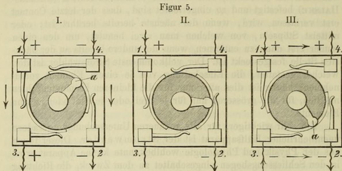
Schema des Stromwenders in 3 verschiedenen Stellungen der durch den Hebel a drehbaren Hartgummischeibe. Contact 1 und 2 stehen mit der Batterie in Verbindung, 3 und 4 führen in den Schliessungsbogen weiter. In I ist bei 3 die Anode, in III ist bei 4 die Anode, die Stromesrichtung in Schliessungsbogen also umgekehrt. In II ist die Kette geöffnet.
