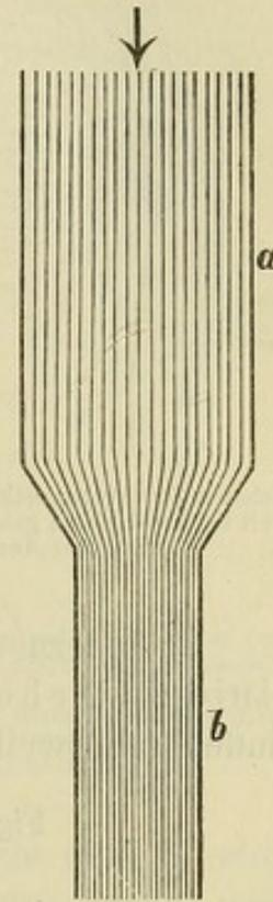
Schema der verschiedenen Stromdichten bei gleichbleibender Stromstärke; die gleiche Anzahl Stromfäden in der Strecke b des Leiters auf den halben Querschnitt zusammengedrängt, wie in Strecke a; folglich in b die Stromdichtigkeit doppelt so gross als in a.
