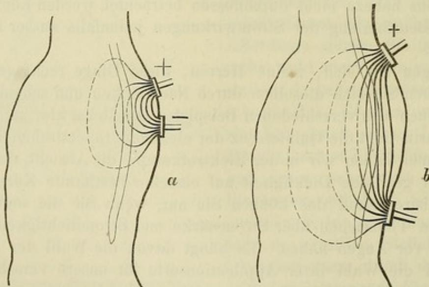
Schema der Vertheilung und Dichtigkeit der Stromfäden mit Rücksicht auf ihr Eindringen in die Tiefe (hier in das Rückenmark), a: bei nahe beisammen stehenden, b: bei weit auseinanderstehenden Elektroden.
