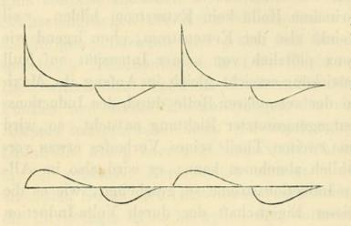
zögert wird. Inductionsvorrichtungen, nach diesen Ueberlegungen gebaut, arbeiten nicht mehr nach dem oberen, sondern nahezu nach dem unteren Schema der nebenstehenden Zeichnung. Weitere Betrachtungen über die Gleichmässigkeit beider Inductionsströme hat du Bois-Reymond angestellt\*).
