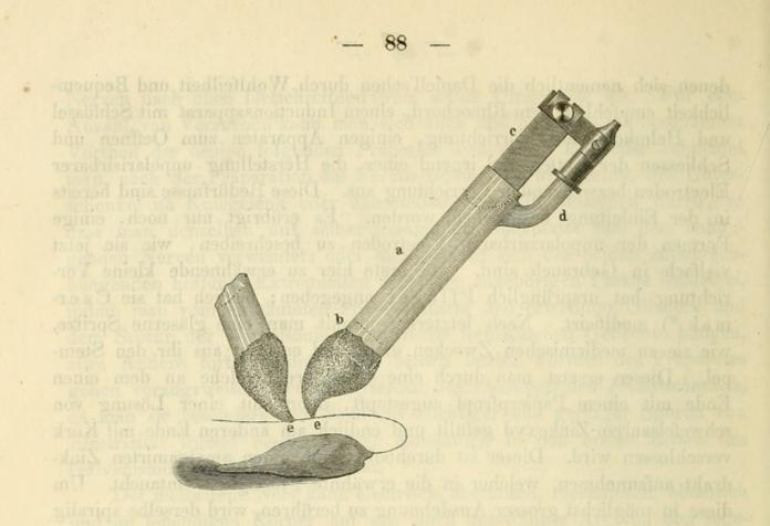
gung befestigt werden kann. Endlich lässt sich der die Röhre verschliessende Thonpfropf in eine feuchte Spitze e formen, und eignet sich vortrefflich als Electrode zur Anlegung an einen zu reizenden Nerven.
