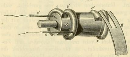
ihm gibt nebenstehende Figur eine deutlichere Ansicht. Er hat den Zweck, die im Draht bei einer einmaligen Umdrehung des Inductors- in ihrer *Richtung wechselnden* Ströme in
