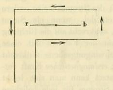
Das Multiplicatorgewinde. Ist r b Fig. 4 eine Magnetnadel und wird ein Stromleiter ober- und unterhalb derselben hergebogen, so wirken beide Drahttheile in demselben Sinn ablenkend auf die Nadel ein. Hat z. B. der Strom die vom Pfeil angedeutete Richtung, so wird sich der Nordpol b senkrecht vor die Ebene des Papiers zu stellen streben. Mit der Anzahl der um die Nadel gelegten
