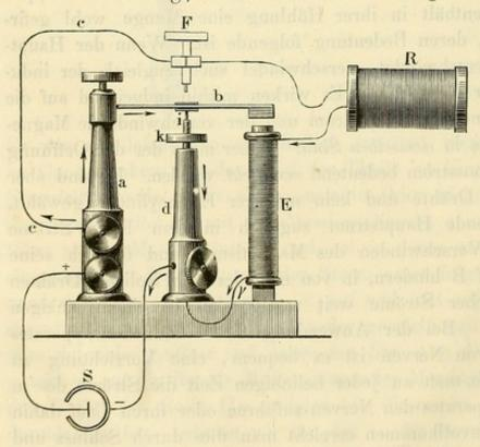
beistehenden Figur bedeutet S die Kette, deren positiver Pol zu der Säule a führt. welche die schwingende Feder b trägt. Von a führt eine Drahtverbindung c zu dem einen Ende der inducirenden Rolle R. Das andere Drahtende derselben führt zu den Windungen des die Feder beherrschenden Electromagneten E. Das Ende y dieser Win-
