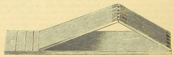
Fig. 78b. Dasselbe; Ersatz der Charniere durch Lederriemen, der Zähne durch Reihen halbeingeschlagener Nägel.
