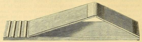
Fig. 78 a. Dasselbe; Ersatz der Charniere durch Leder, der Zähne durch aufgenagelte Holzleisten.
