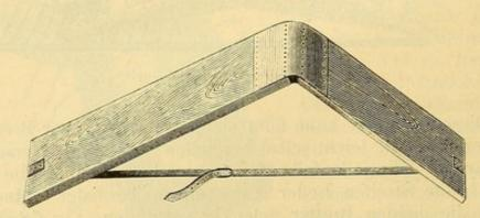
Fig. 78c. Dasselbe; die Charniere durch ein breites Leder ersetzt; anstatt des Unterlage-Brettes sind die beiden schiefen Ebenen durch einen Riemen ersetzt, durch dessen kürzeres oder längeres Anschnallen man den Winkel und die Neigung der beiden Ebenen beliebig verändern kann.
