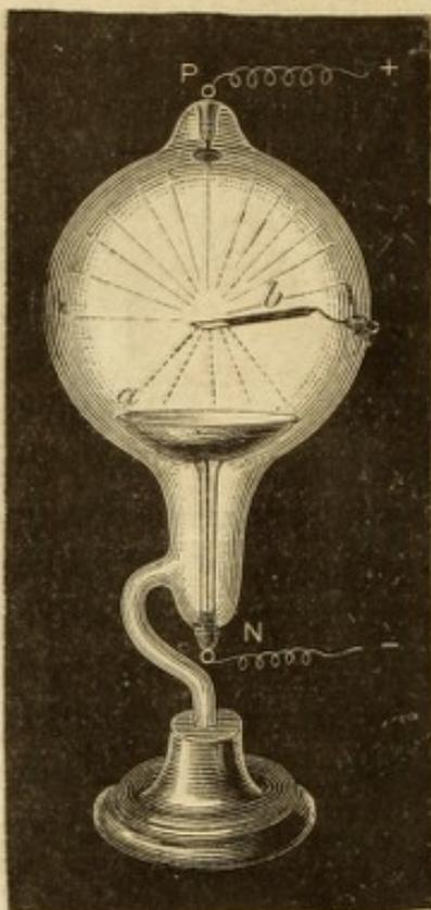
si je la fais tomber sur un fragment de métal. Cette boule (*fig. 21*) est munie d'un pôle négatif sous la forme d'une calotte *a*. Les rayons seront, par conséquent, concentrés dans un foyer où l'on place et maintient un fragment d'iridoplatine *b*. D'abord, je tourne à peine la bobine d'in-
