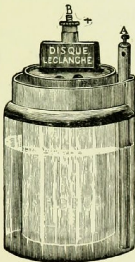
FIG. 6.—LECLANCHÉ VOLTAIC CELL.
