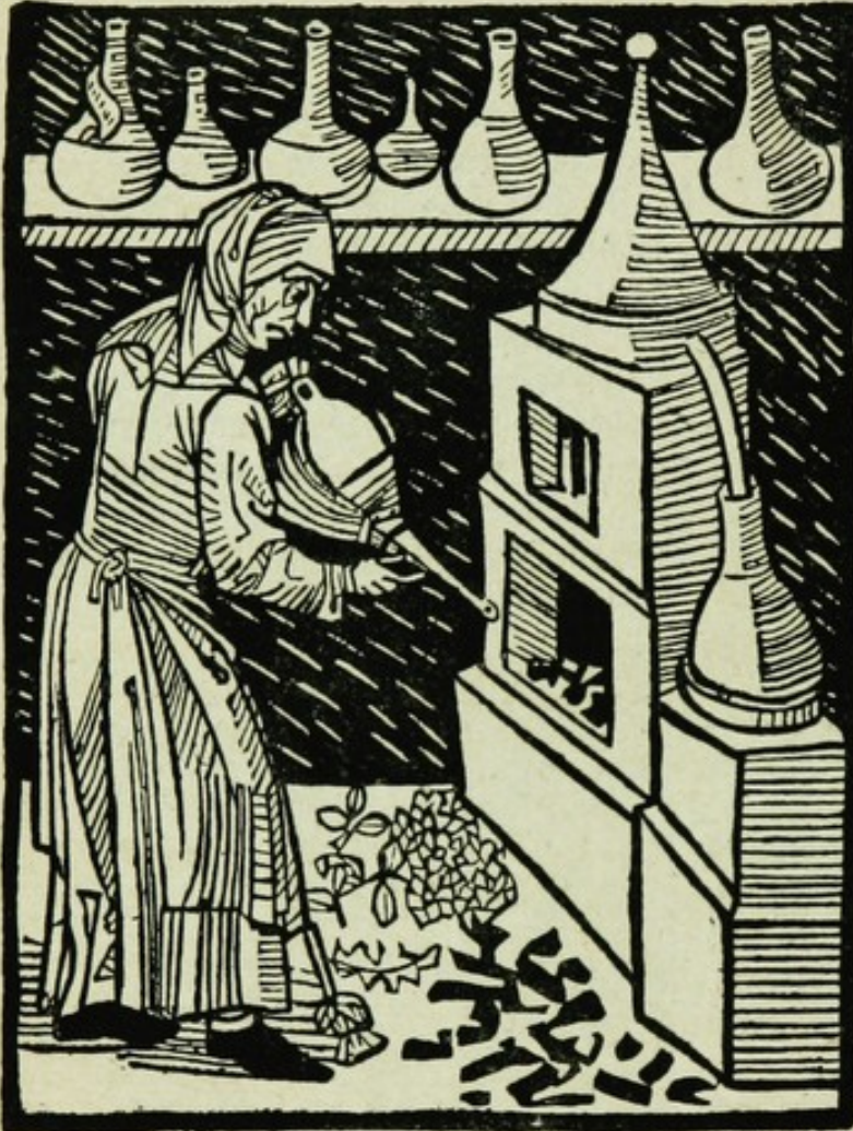
Abb. 97. Wasserbrennerin benutzt zur Destillation als Brenngeschirr den sog. „Rosenhut“. Titelholzschnitt aus: M. Schrick, von den uszgebrenten Wassern. Straßburg, Knoblauch, 1519.
