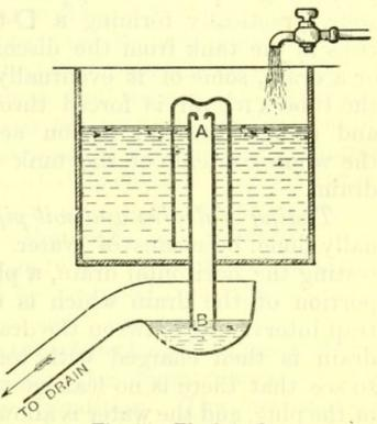
Fig. 15 .- Flush-tank.
