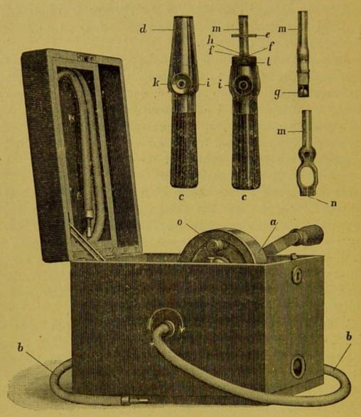
a) motore — b) asse flessibile, spirale che trasmette il movimento rotatorio — c) manubrio alla estremità del quale si innastano i contatti, e che racchiude l'eccentrico — l) produttore delle vibrazioni.
