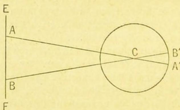
apothèmes. Ceci posé, quand on projette l'image consécutive sur un écran, l'écran coupe ce cône, et la grandeur et la forme de la section conique sont celles de l'objet qui, à la distance où on tient l'écran, produit une image rétinienne égale à  $A'B'$  ; par conséquent ce sont aussi celles de l'image consécutive projetée. Ainsi, quand on tient l'écran verticalement (c'est-à-dire perpendiculairement à l'axe optique), l'image consécutive doit avoir la forme circulaire, car
