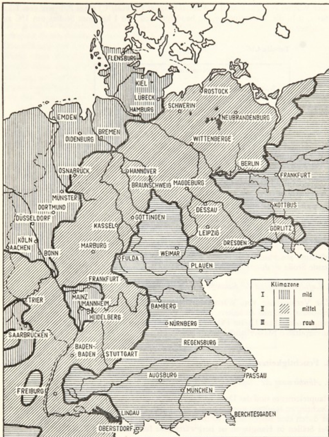
Abb. 4.3 Klimazonenkarte nach DIN 18910 Blatt 1. Die auszugsweise Wiedergabe der Norm erfolgt mit Genehmigung des Deutschen Normenausschusses
