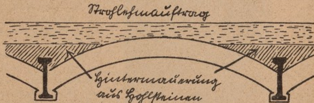
Abb. 7. Verbesserung massiver Stalldecken. Übermauerung von Eisenträgern
