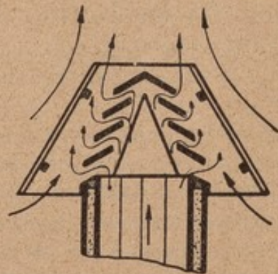
Abb. 13 Schnitt durch die Windschutzhaube
